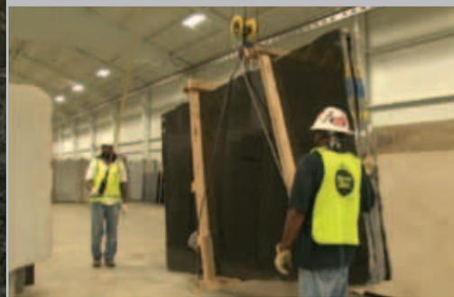
*Déplacement d'une dalle avec un pont roulant*
